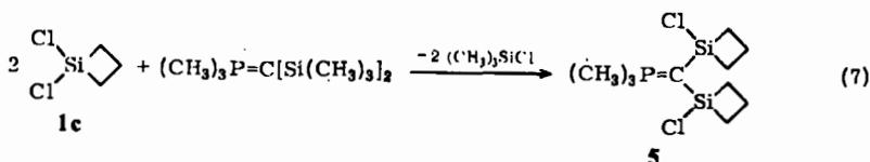
Dabei entsteht unter Abspaltung von Trimethylchlorsilan das [Bis(1-chlor-1-sila-1-cyclobutyl)methylen]trimethylphosphoran (5). Dieses Produkt ist dem Phosphoran 6 vergleichbar, das nach folgender Reaktion erhalten wurde<sup>3)</sup>:
